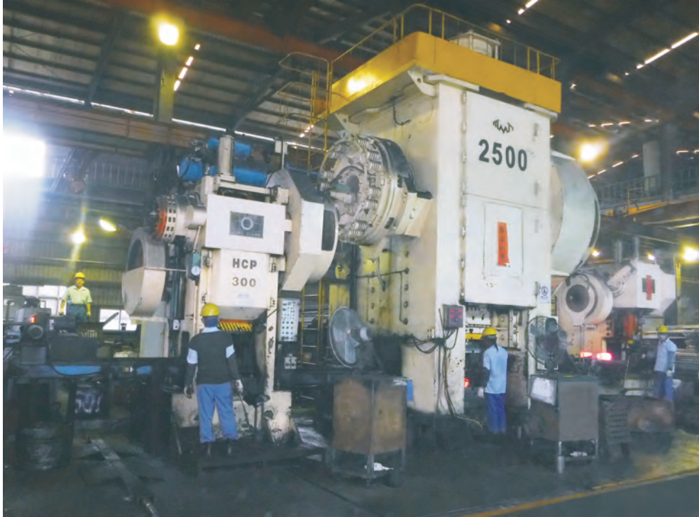
沖床及感應加熱設備鍛造設備操作現場 ▲
